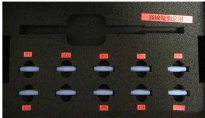
高線量測定用 (IMRT等) 10素子 (No.10 : BG用)
